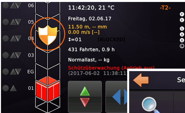
Abbildung 11: Aufzug in 'Sperrung'
