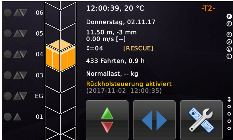
Abbildung 28: Aufzug im Inspektions-/Rückholsteuerungsbetrieb
