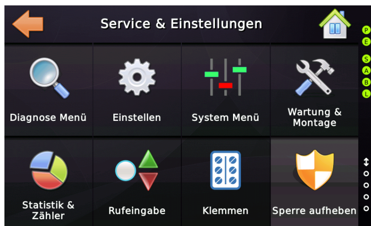
Abbildung 124: Abschließend Freigabe der Steuerung, Aufheben der Blockierung
