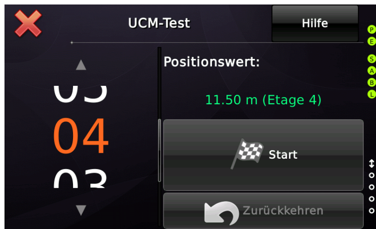
Abbildung 115: Der Hauptbildschirm des Testassistenten zeigt die aktuellen Etage und lässt den Benutzer die Richtung wählen, indem er die Ziffern auf der linken Seite nach oben oder unten verschiebt oder "wischt".
