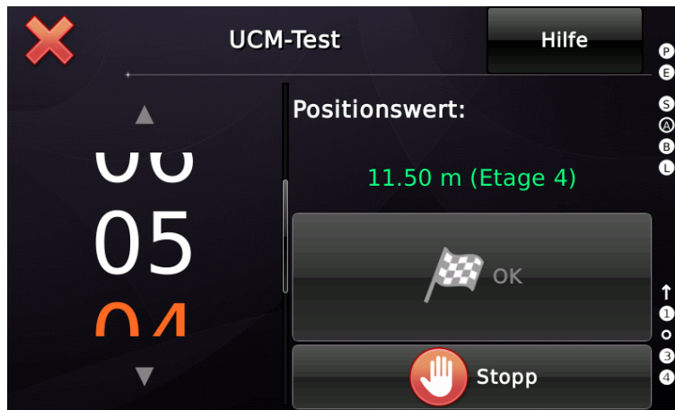
Abbildung 117: Der Test wurde mit dem von der NOUS-SZ-Platine überbrückten Sicherheitskreis nach oben gestartet. Mit der Stopptaste kann der Vorgang abgebrochen werden.
