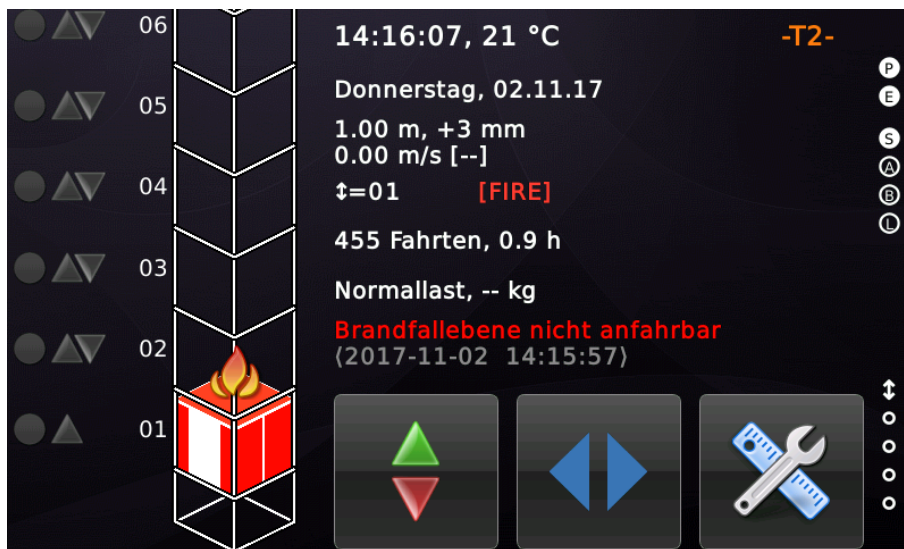
Abbildung 143: Brandfalletage nicht anfahrbar
