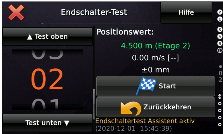
Abbildung 104: Fahrt zu einer Etage vor dem Endhalt
