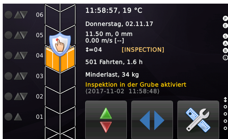
Abbildung 9: Aufzug wartet auf Inspektionssteuerung-Grube Reset
