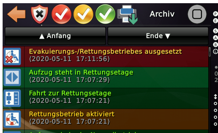
Abbildung 149: Evakuierungsbetrieb per Eingangssignal unterbrochen/ausgesetzt
