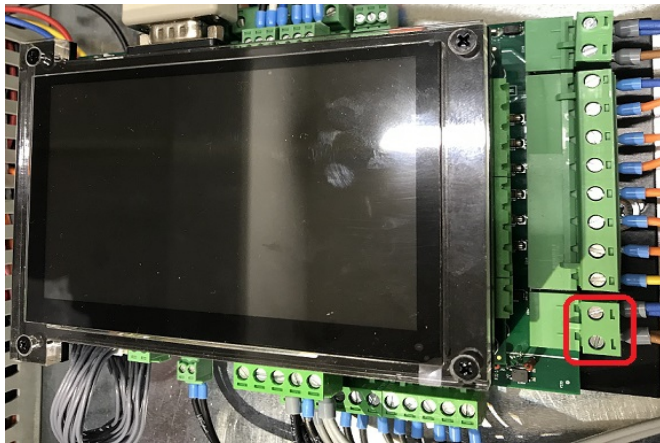
Abbildung 69: Netzausfallüberwachung am SB-Board (Referenzhardware)
