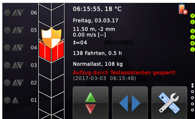
Abbildung 123: Aufzug wieder blockiert nach Beendigung des Testassistenten.
