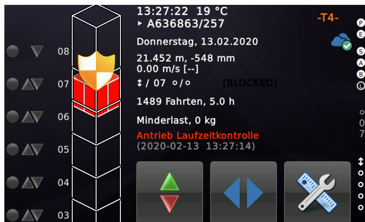
Abbildung 127: Aufzug im Sperrbetrieb durch die Laufzeitkontrolle
